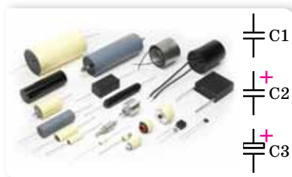
Мал. 25. Конденсатори різної форми та їх схематичне позначення
