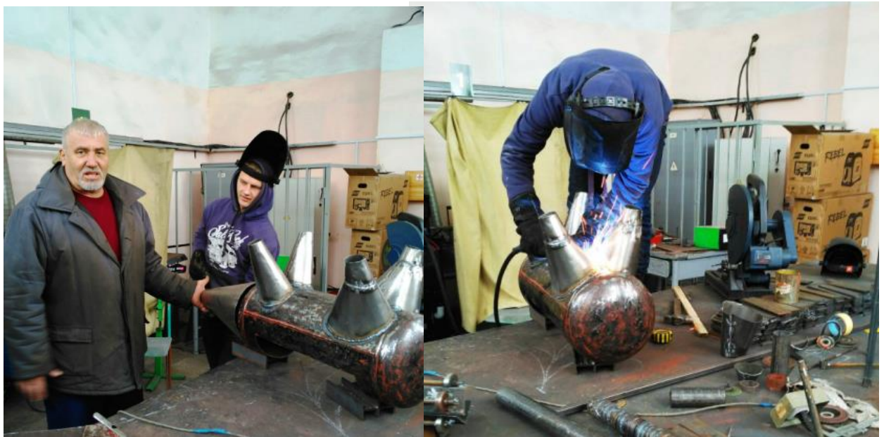
Рис.3. Збирання і зварювання конструкції в майстерні ліцею
